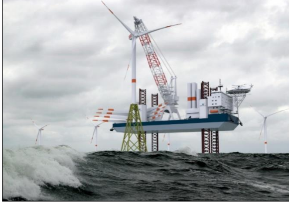
Şekil 8.37. Jack up gemi vinci ile montaj.
