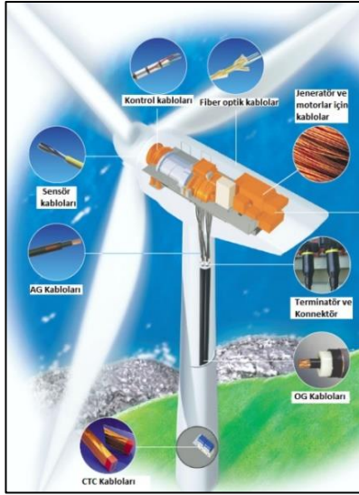
Şekil 6.16. DRT’de kullanılan kabloların çeşidi.
