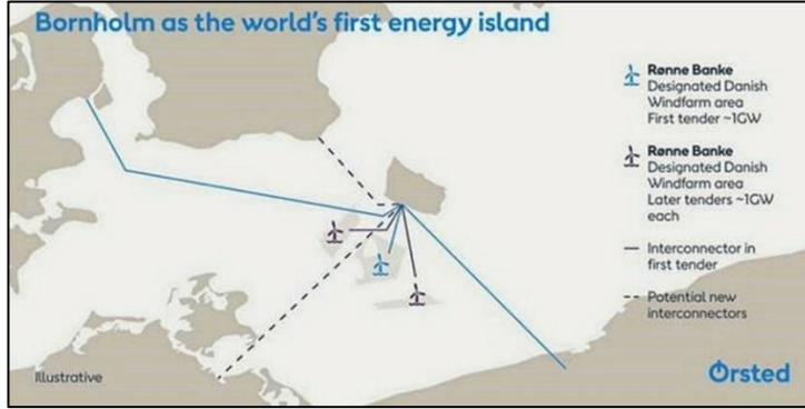
Şekil 11.11. Enerji adası bağlantı noktaları.
