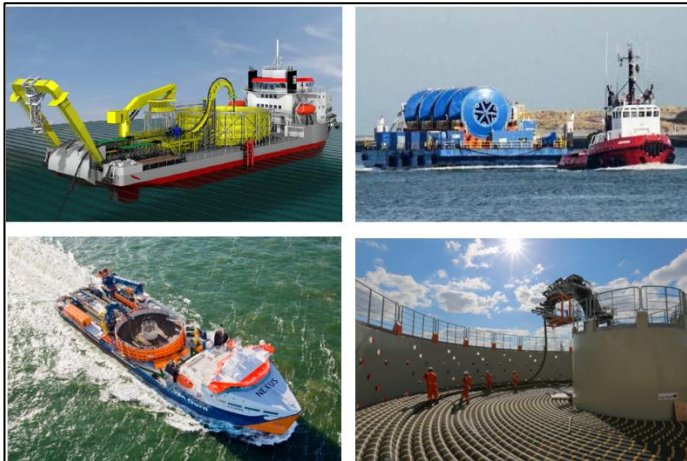
Şekil 8.31. Denizaltı kablolanma için kullanılan özel gemiler.
